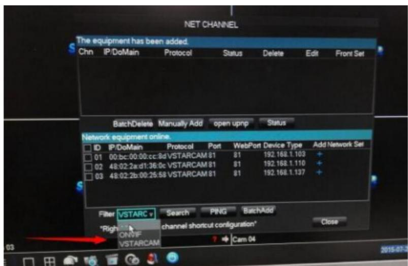
5. Klikkeljen duplán vagy válassza ki a készülék által érzékelte kamerát. A zöld fény jelzi a Status oszlopból, hogy a kamera megfelelően van csatlakoztatva a DVR-hez. A piros csatlakozási hibát jelöl.
