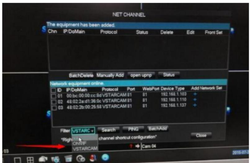
5. Kliknij dwukrotnie lub zaznacz kamerę wykrytą przez urządzenie, zielona lampka świecąca się w oknie Status oznacza, że kamera została prawidłowo połączona z rejestratorem, czerwona oznacza błąd podczas łączenia.
