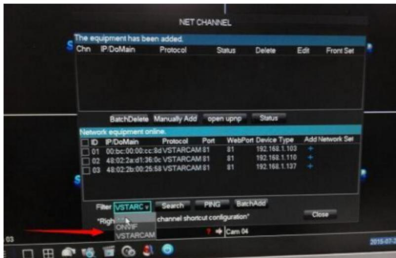
5. Dvojklikom alebo výberom kamery detekovanej zariadením. Zelené svetlo svietiace vo stavovom okne indikuje, že je kamera správne pripojená k DVR. Červené znamená chybu pripojenia.
