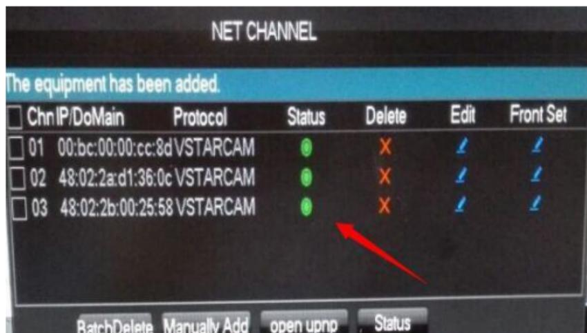
6. A megfelelően csatlakoztatott kamera az élő képet közvetíti a DVR-felé.
