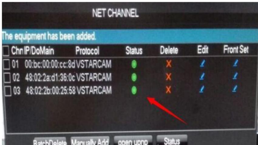
6. Poprawnie podłączona kamera wyświetli obraz w czasie rzeczywistym
