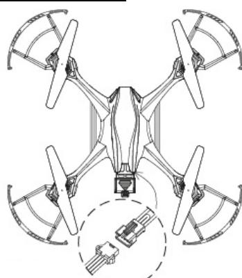
Propojte zástrčku baterie se zástrčkou v kapsě pro baterie dronu, viz obrázek. Zasuňte baterii do kapsy tak daleko, dokud se neozve cvaknutí. Vložená a zajištěná baterie je připravena k činnosti.
