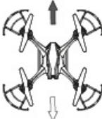
Pokiaľ sa dron automaticky pohybuje dozadu, stlačte "Kláves pohybu dopredu". Pokiaľ sa dron automaticky pohybuje dopredu, stlačte "Kláves pohybu dozadu".
