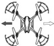
Posunutím páčky ovládania smeru vľavo / vpravo poletí dron požadovaným smerom.
