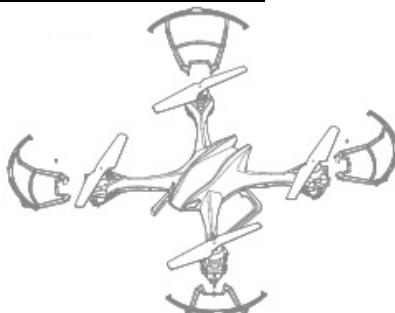
Nałożyć osłony śmigieł na końce ramion drona, tak aby profile osłon wsunęły się w prowianice, umieszczone na ramionach. Zabezpiecz osłony wkręcając dołączoną do zestawu śrubkę.
