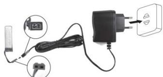
Utilizati incarcatorul furnizat pentru a incarca bateria dronei.
